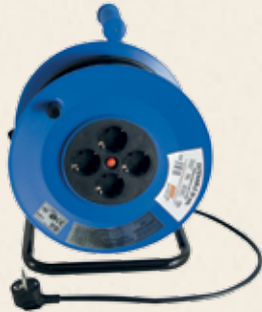
Cód. 64398 EXTENSIBLE ELÉCTRICO CON TERMOSTATO. TAYG Extensible eléctrico 50 metros. Cable H05VV-F 3x1'5. 4 bases 2P+T con termostato. 230V 13A 3000W. Diámetro de carrete 265 mm. IP-20. 44,95€ + 9,44 IVA = 54,39€
