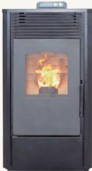
Cód. 97595 ESTUFA DE PELLETS 13,5KW PS-50. MADER Potencia regulable 9,5kw. 13,5kw. Rendimiento 80%. Depósito 16kg. Tubo salida humos Ø80-50mm. Control remoto.
