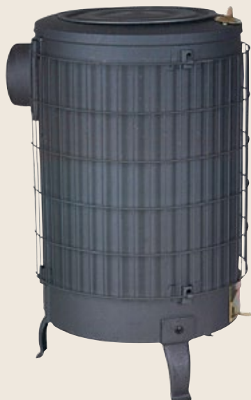
Cód. 31875 ESTUFA LEÑA NEGRA N°4. THECA Negra sin parrilla. Salida de humos horizontal ø 110 mm. Combustible: sólo madera. Altura 610mm /diámetro 383mm / diámetro de carga 240mm. Potencia calorífica 14,5 kw. / Marcado CE
