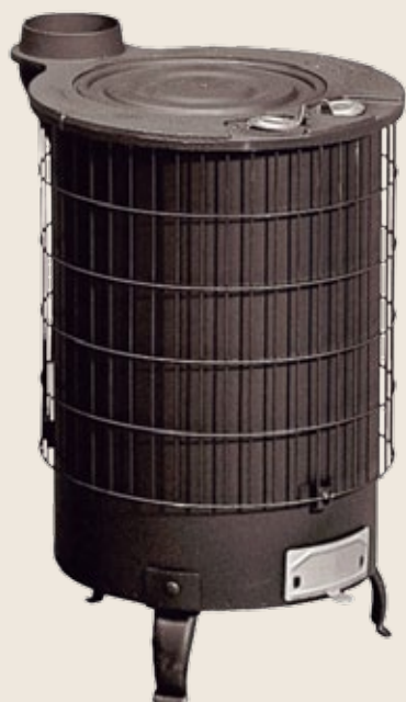
Cód. 6285 ESTUFA NEGRA MIXTA LEÑA N°3. THECA Salida de humos vertical ø 110 mm. Combustible: sólo madera. Altura 600mm /diámetro 383mm / diámetro de carga 240mm / potencia calorífica 14,5 kw. / Marcado CE
