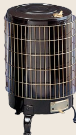
Cód. 27734 ESTUFA LEÑA ESMALTADA N°4. THECA Esmaltada con parrilla. Salida de humos horizontal ø 110 mm. Combustible: sólo madera. Altura 610mm /diámetro 383mm / diámetro de carga 240mm. Potencia calorífica 14,5 kw. / Marcado CE
