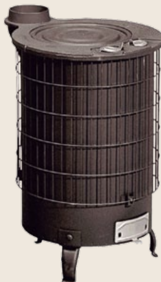
Cód. 6280 ESTUFA NEGRA MIXTA LEÑA N°2. THECA Salida de humos vertical ø 100 mm. Combustible: sólo madera. Altura 560mm /diámetro 348mm / diámetro de carga 190mm / potencia calorífica 14 kw. / Marcado CE
