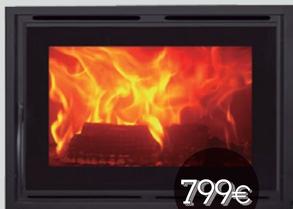
Cód. 102758 ESTUFA ENCASTRABLE C-720-S. PANADERO Insert de potencia nominal 11-14 Kw y rendimiento del 75%. Salida de humos vertical de 150 mm. Troncos hasta 50 cm. Medidas del insert 70x76x57 cm (alto, ancho, fondo). Pintura anticalórica de resistencia 800°C y cristal vitrocerámico de resistencia 750°C. Combustible leña. Hogar revestido de vermiculita y puerta en vidrio serigrafiado. Equipado de un ventilador tangencial e interruptor para expulsar el aire caliente en la habitación. Visión panorámica del fuego. Dispone además de 2 salidas de 120 mm para tubos flexibles, con el fin de distribuir el calor a otras estancias.
