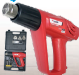
Cód. 86756 DECAPADOR 2000W. MADEIRA Soplador aire caliente 2000 W. Incluye 9 accesorios Temperaturas de trabajo : 350°C y 550°C Flujo de aire :300l/min y 500L/min.
